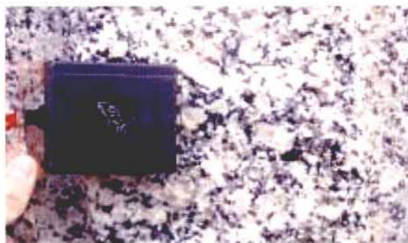
Fotografía 3.10.17. Detalle textural del granito Gris Perla (Facies externa del Macizo de Caldas de Reis).
