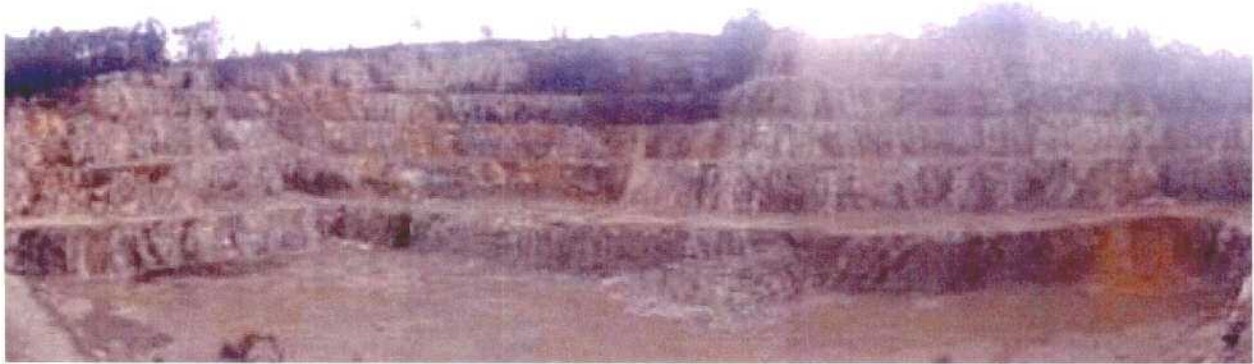
Fotografía 3.10.28. Aspecto de una cantera de áridos de machaqueo en la facies Gris Mondariz, en el Macizo de O Porriño (N_2: 55).
