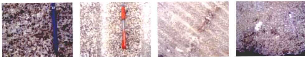
Fotografía 3.10.6 Aspectos de detalle de la variedad "Pedra do País" en corte fresco (N_2: 36 y 99) y corte alterado con vena aplítica (N_2: 99) "Silvestre moreno" en corte alterado (N_2: 61)
