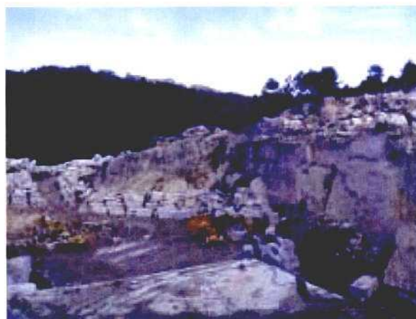
Fotografía 3.10.11. Una parte del frente de explotación en la cantera N_2: 36, donde se extraen bloques heterométricos y semibloques de la variedad "Pedra do país".
