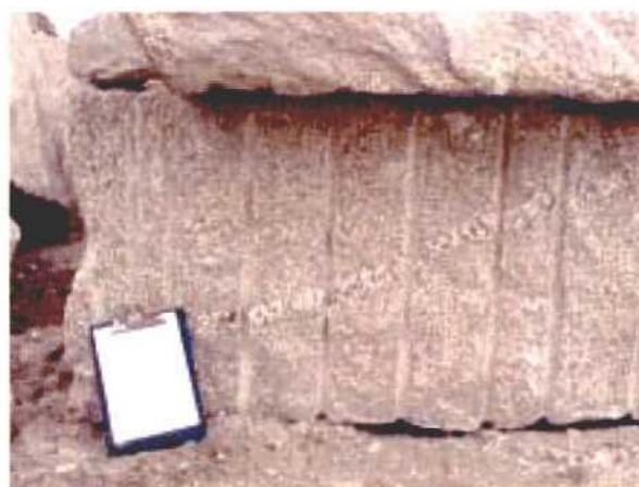
Fotografía 3.10.9. Semibloque de granito "Albero" cruzado por una veta cuarzo-feldespática. Cantera N_2:112.
